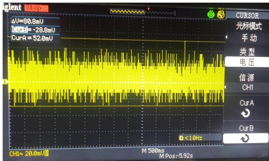
图 2-8 接了 470uF 滤波电容之后的纹波图
